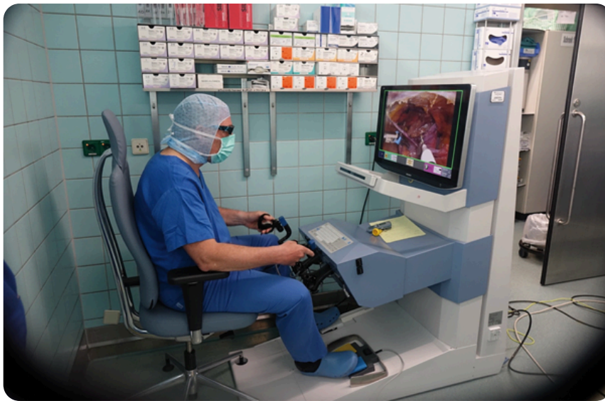
Abb. 1: Konsole des robotischen Senhance-Systems. Zu erkennen sind die entspannte Sitzhaltung des Operateurs, der Eye-Tracker (schwarzer Balken unterhalb des Monitors), das Bedienungsdisplay am unteren Bildschirmrand, und die Handles mit Forced Feedback, die analog zu MIC-Handstücken bedient werden. Operation: TAPP.
