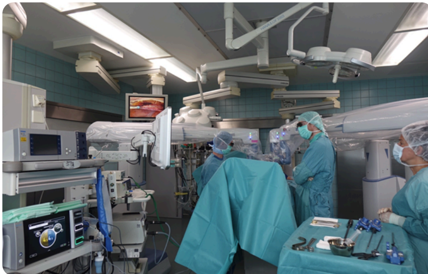
Abb. 2: Ausrichtung der Roboterarme des robotischen Senhance-Systems. Zu erkennen sind die drei separat stehenden Roboterarme, die Magnet-Andockung der Instrumente und die Position des assistierenden Personals. Operation: TAPP.
