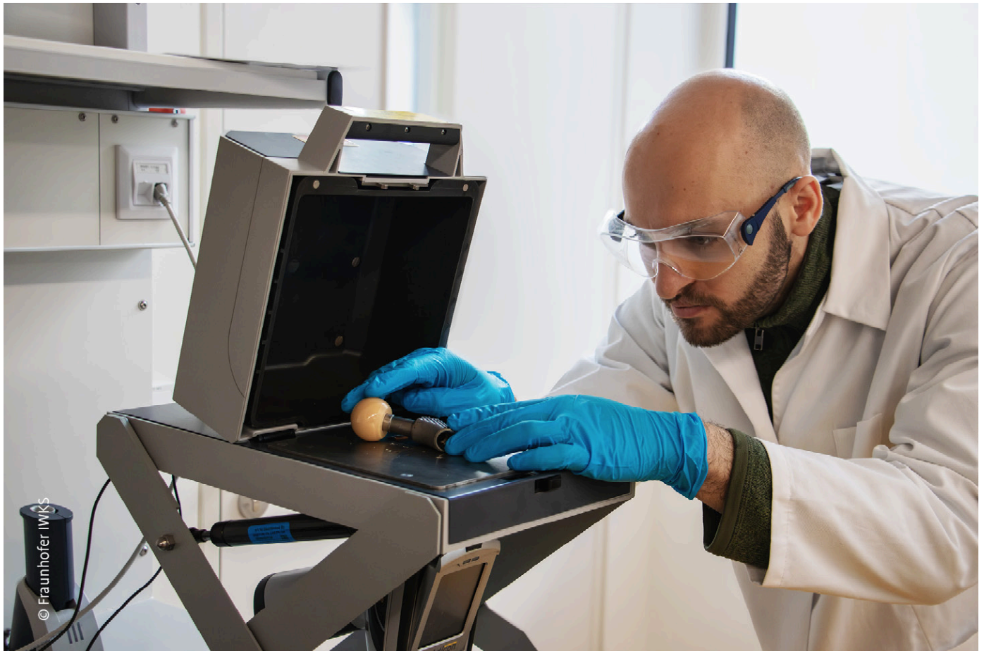
Abb. 3: Bestimmung der Materialzusammensetzung einer Endoprothese mittels Röntgenstrahlen (im Bild: Hr. Hikisch)
