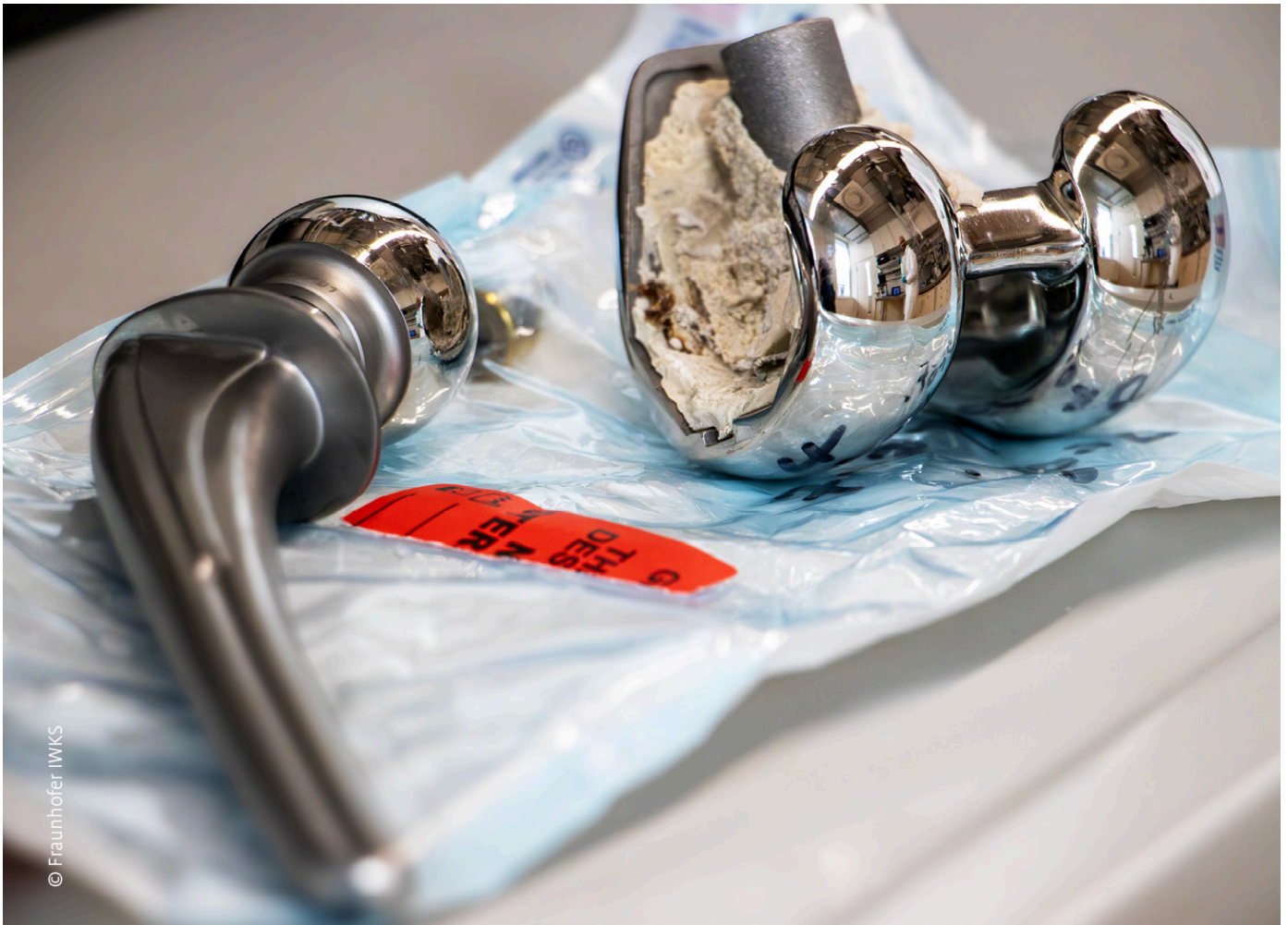
Abb. 5: Darstellung modularer Endoprothesenkomponenten (links: Hüftendoprothese, rechts: Knieendoprothese mit Anhaftungen von Knochenzement)
