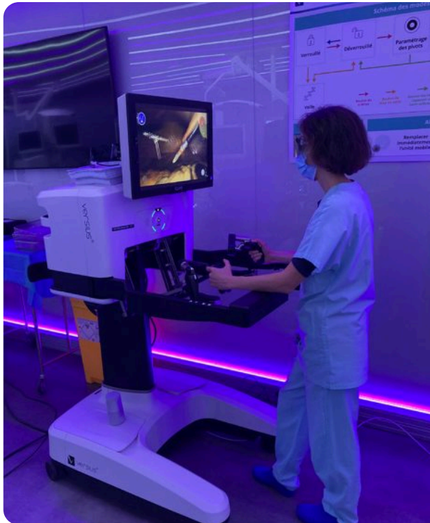
Abb. 5: Ein offenes Konsolendesign, die Möglichkeit einer Bedienung im Stehen sowie ein der Gaming Industrie nachempfunder Controller bieten höchsten ergonomischen Komfort.
